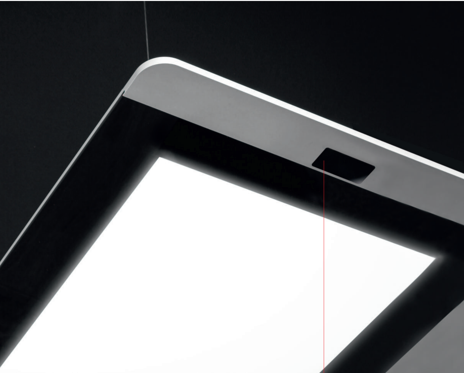
ONYXX AIR SENSO Variante mit Licht- und Bewegungssensor Der Lichtsensor misst die Beleuchtungsstärke auf der Nutzebene (z.B. Schreibtisch) und reguliert die gewünschte Helligkeit des Lichts automatisch. Der Bewegungssensor mit HF-Technologie erkennt An-/Abwesenheit von Personen und aktiviert bzw. deaktiviert die Leuchte automatisch.
